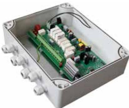
Katso komponenttien asennuksen ja käytön kuvaus oheisesta käyttöohjeesta "Saunaohjain Pro D". Toimintaan tarvitaan aina teho-osa, kiuasanturi ja Ohjauspaneeli (Ohjauspaneeli ei sisällä toimitukseen).
