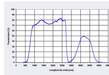
Vidrio oscuro con penetrabilidad de la radiación
