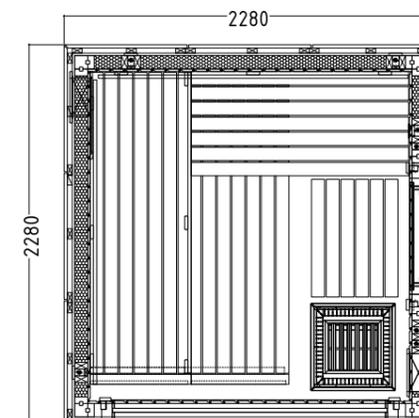
Capacità di riscaldamento della stufa consigliata: 9-10,5 kW
